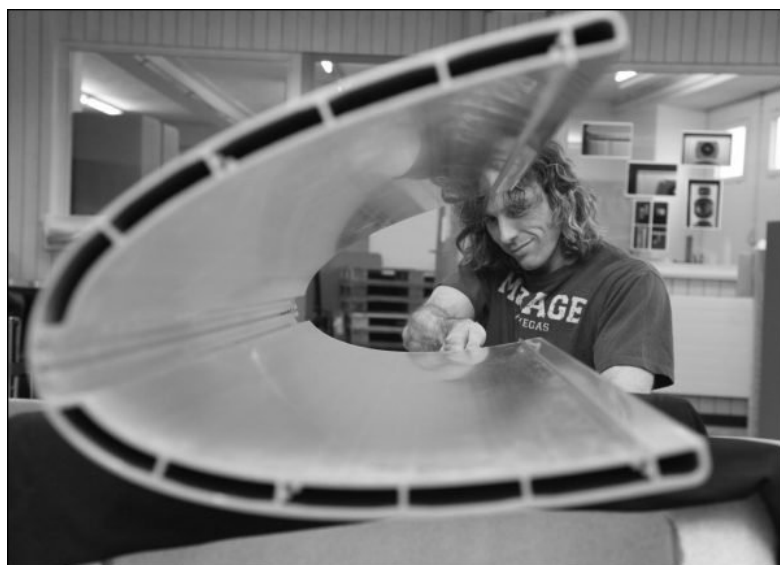
Die massiven Gehäuse minimieren Eigenschwingungen des Lautsprechers. (Bild: ZvG)
